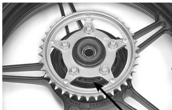
FLANGE DA COROA AMORTECEDORES DE BORRACHA
